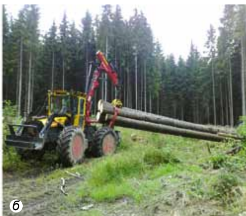
Мал. 17. Заготівля деревини: а – спилування; б – трелювання
