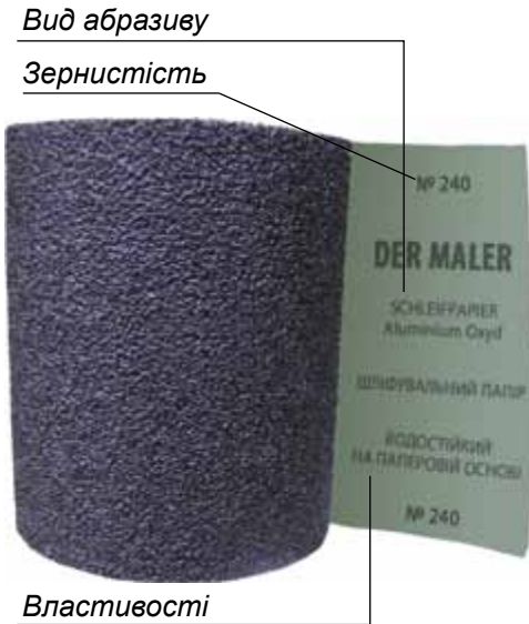
Мал. 83. Позначення на шліфувальних шкурках
