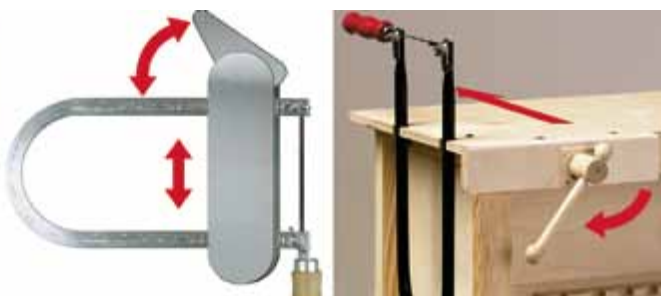
Мал. 56. Пристосування для стягування рамки лобзика
