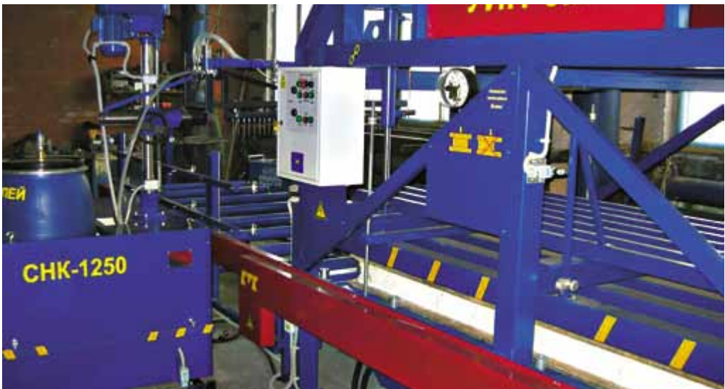
Мал. 29. Автоматична лінія для виготовлення фанери
