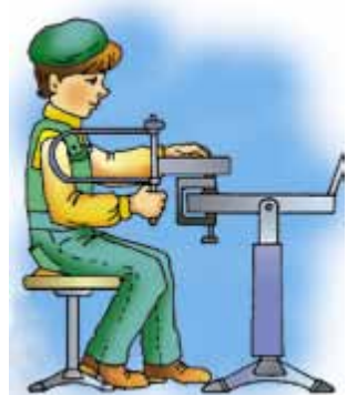
Мал. 58. Положення тулуба при випилюванні
