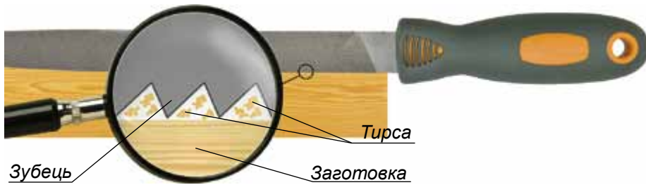
Мал. 89. Схема різальної частини напилка
