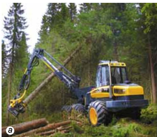
Мал. 17. Заготівля деревини: а – спилування; б – трелювання
