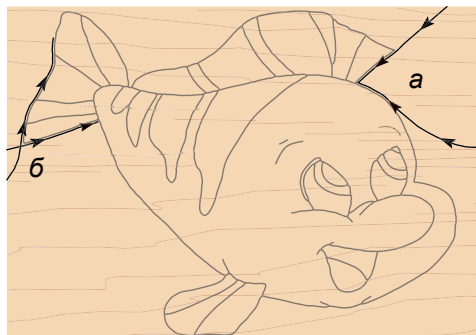
Мал. 62. Випилювання гострих кутів: а – внутрішніх, б – зовнішніх
