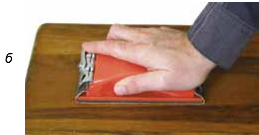
Мал. 84. Кріплення шліфувальної шкурки: а – на колодці (шліфку); б – на пристрої
