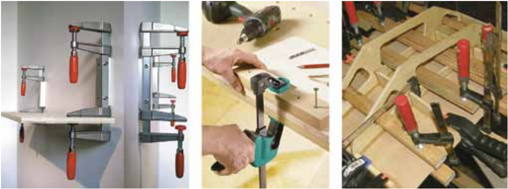
Мал. 106. Ущільнення склеєних деталей струбцинами
