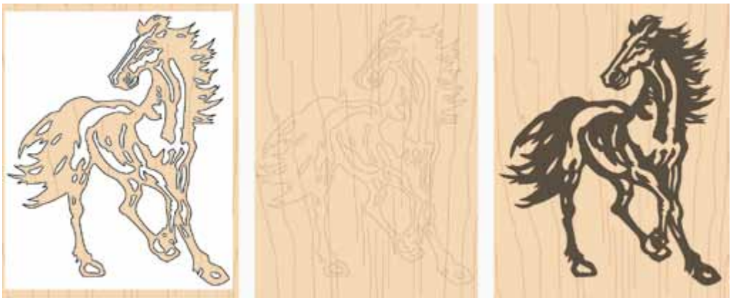
Мал. 143. Розмічання за трафаретом: а – трафарет; б – зображення контурів на заготовці; в – випалене зображення
